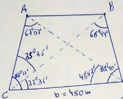
Los ángulos de  $67^{\circ} 57'$  y  $66^{\circ} 44'$  no son necesarios que los de el problema, se puede calcular con los otros datos. En esta figura hay 8 triángulos y se puede hacer de varias formas. Tomamos el triángulo  $\widehat{BCD}$  y calculamos  $\overline{BC}$  por el teorema de los senos:
