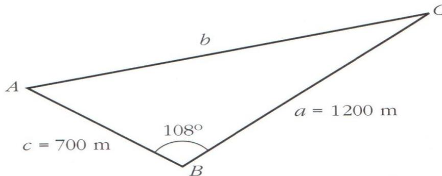
Aplicamos el teorema del coseno para calcular el lado
