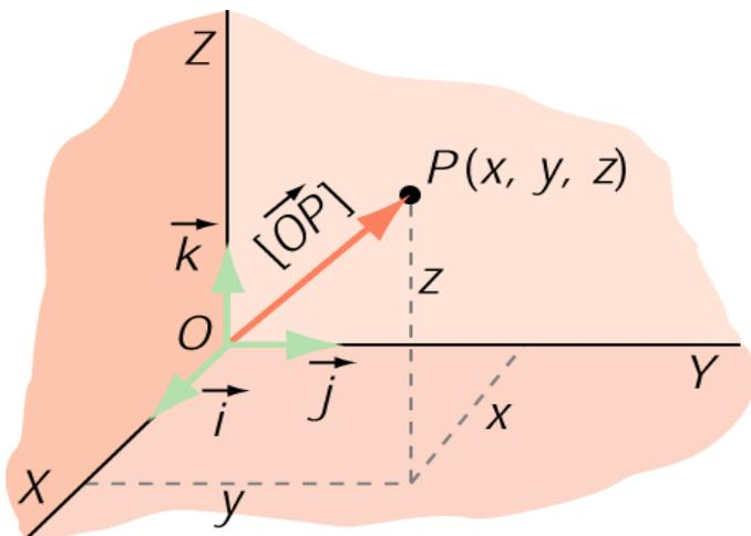
Llamamos coordenadas de un vector fijo  $\vec{AB}$  de origen el punto  $A(a,b,c)$  y extremo el punto  $B(d,e,f)$  a los números que se obtienen de restar a las coordenadas del extremo las coordenadas del origen:
