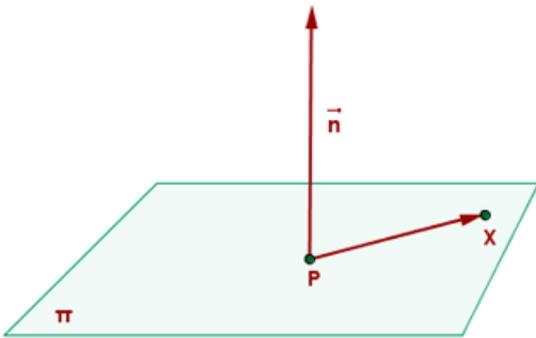
Con esto, un plano también queda unívocamente determinado por un punto por donde pase,  $A(x_1, y_1, z_1)$ , y un vector normal a él,  $\vec{n} = (A, B, C)$
